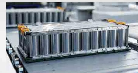
Die Illustration rechts zeigt das Konstruktionsprinzip des Elektro-Subaru mit seiner Fahrbatterie (Mitte) und den elektrischen Motoren auf den Achsen. Die Illustration oben zeigt beispielhaft den Aufbau einer Fahrbatterie. Eine von mehreren gängigen und mittlerweile bewährten Konstruktionsweisen ist der Einsatz von Rundzellen mit festem Gehäuse.
