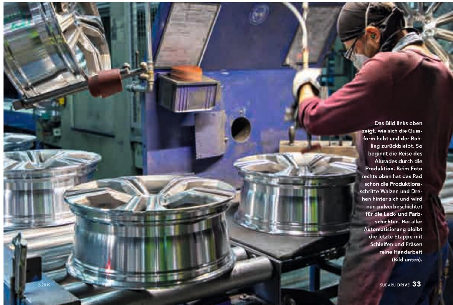
Das Bild links oben zeigt, wie sich die Gussform hebt und der Rohling zurückbleibt. So beginnt die Reise des Alurades durch die Produktion. Beim Foto rechts oben hat das Rad schon die Produktionschritte Walzen und Drehen hinter sich und wird nun pulverbeschichtet für die Lack- und Farbschichten. Bei aller Automatisierung bleibt die letzte Etappe mit Schleifen und Fräsen reine Handarbeit (Bild unten).
