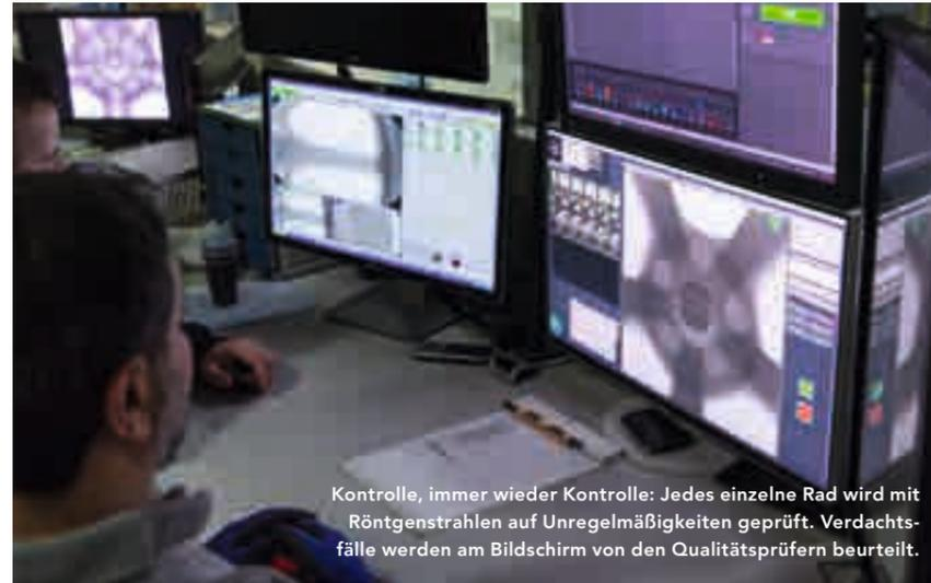
Kontrolle, immer wieder Kontrolle: Jedes einzelne Rad wird mit Röntgenstrahlen auf Unregelmäßigkeiten geprüft. Verdachtsfälle werden am Bildschirm von den Qualitätsprüfern beurteilt.
